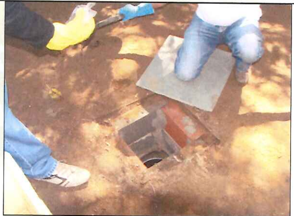
Figura 5 – Coleta de material no recipiente 3 da fossa séptica instalada no município de esmeraldas
