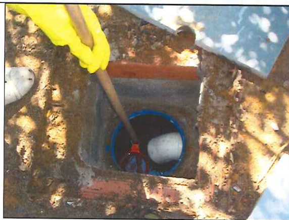
Figura 2 - Coleta de material no recipiente 1 da fossa séptica instalada no município de Esmeraldas
