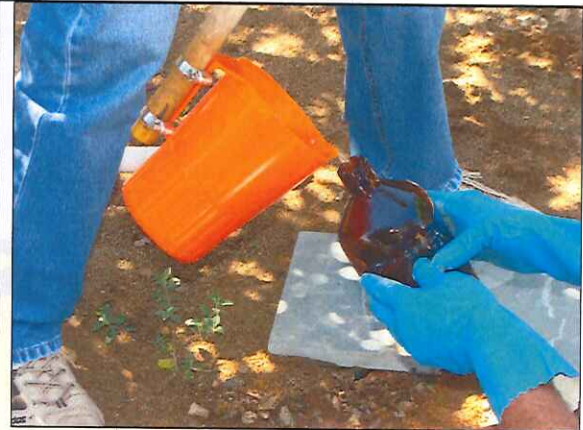
Figura 3 – Acondicionamento do material coletado para envio ao laboratório de análises
